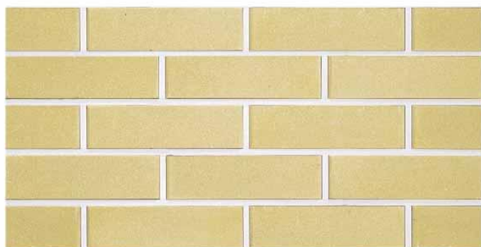
Кирпич на основе ракушечника и необожженной глины
