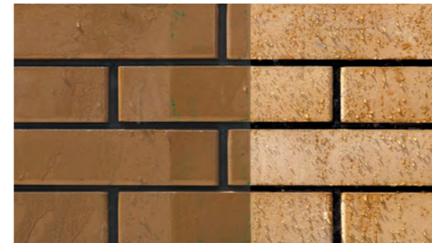
Не обработанный кирпич (слева) намокает, а обработанный (справа) отталкивает воду
